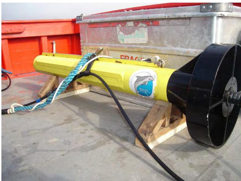
Figura 1. Transdutor do sonar de varredura lateral
