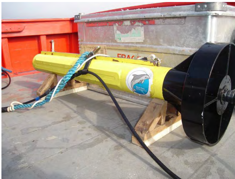
Figura 1. Transdutor do sonar de varredura lateral
