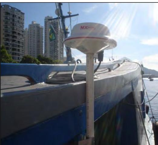
*Antena do DGPS instalada na embarcação, utilizada para captação do sinal do satélite.*
