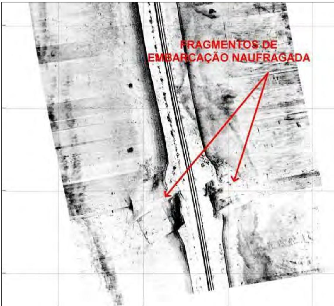
*Registro do sonar de varredura lateral mostrando fragmentos de embarcação naufragada no Canal de Santos (Navio Ais Georges, naufragado em 1974).*
