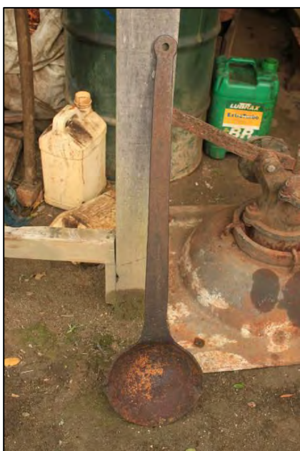
Cadinho de fundição em ferro fundido, utilizado para derreter as broas de chumbo, o qual é utilizado nos reparos do conduto forçado (Segmento 8).
