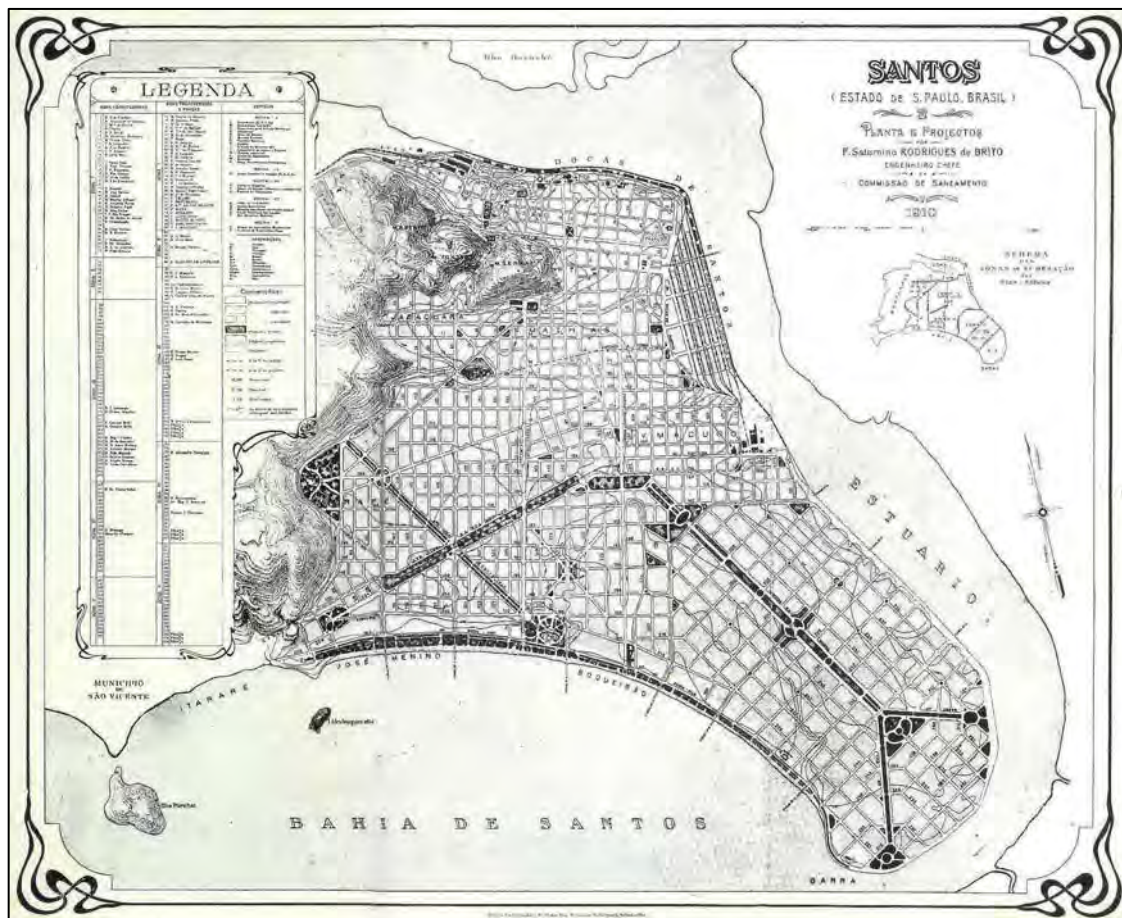
Planta de 1910 do Plano de Saneamento de Santos, por Saturnino de Brito.
