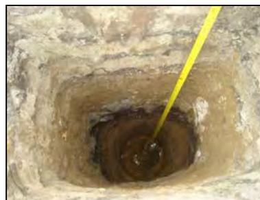
Em geral, assim como nos demais poços teste realizados, as prospecções efetuadas na área da Garagem da CODESP também culminaram com a constatação de camadas de aterro, predominantemente com a presença de cascalho, brita e blocos rochosos, sobrepostos a um solo de matriz arenosa sem a presença de material arqueológico e primitivamente sujeito a processos de inundação.
