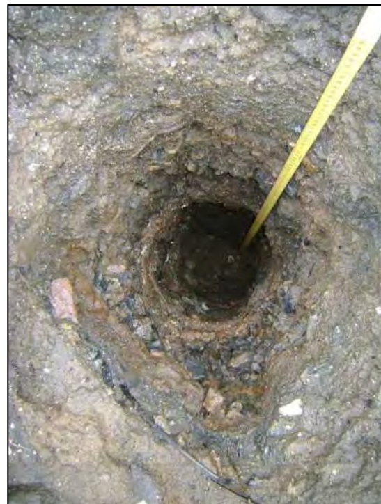
Aprofundamento do PT e medição de profundidade.
