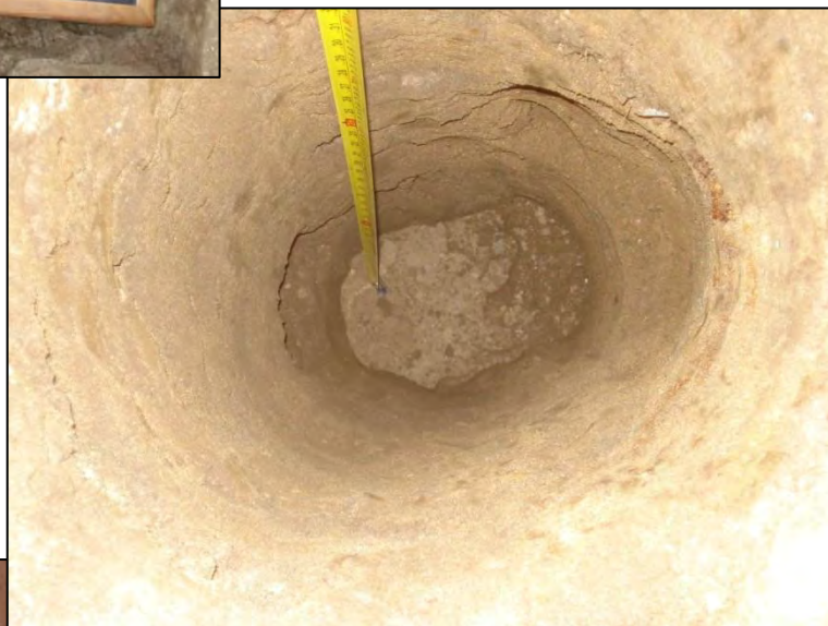
Aprofundamento do PT e medição de profundidade.
