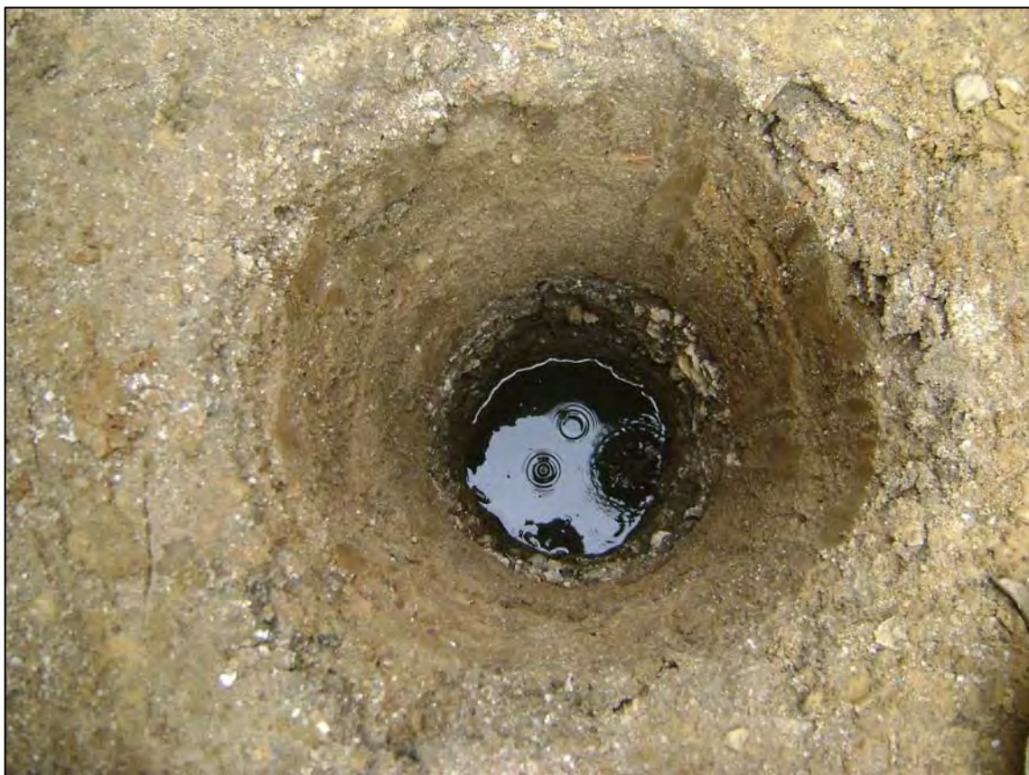
Aprofundamento do PT e medição de profundidade.
