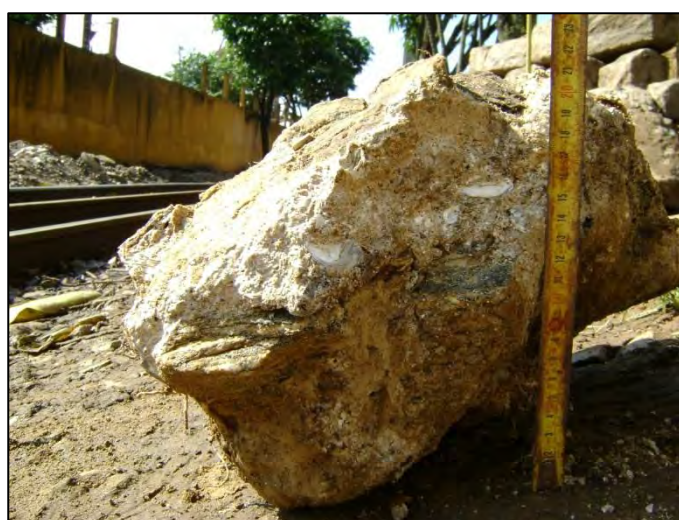
Bloco granítico argamassado com técnica de pedra e cal.
