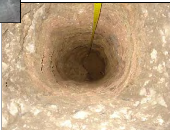
Aprofundamento do PT e medição de profundidade.
