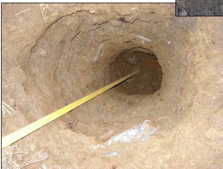
Aprofundamento do PT e medição de profundidade.
