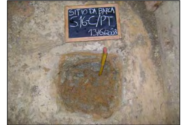
Poço-teste na base da Quadra C. Notar a generalizada ocorrência de blocos rochosos graníticos na base da sondagem.
